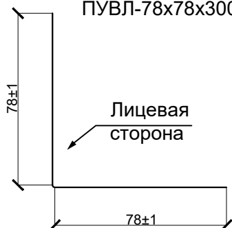
Планка угла внутреннего линейного ПУВЛ-78x78x3000
