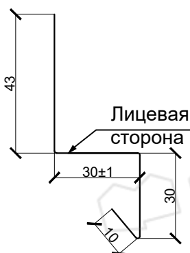
Планка вертикального стыка ПВС-30x30x3000
